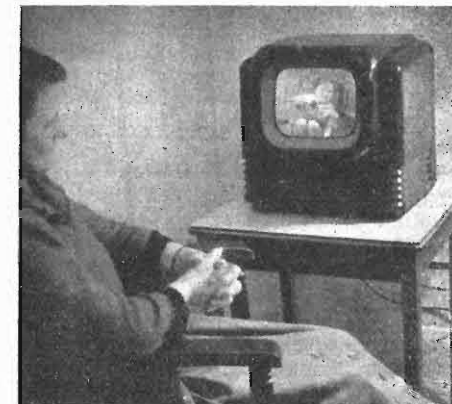
Un ricevitore economico inglese con tubo catodico da 9 pollici (23 cm).
